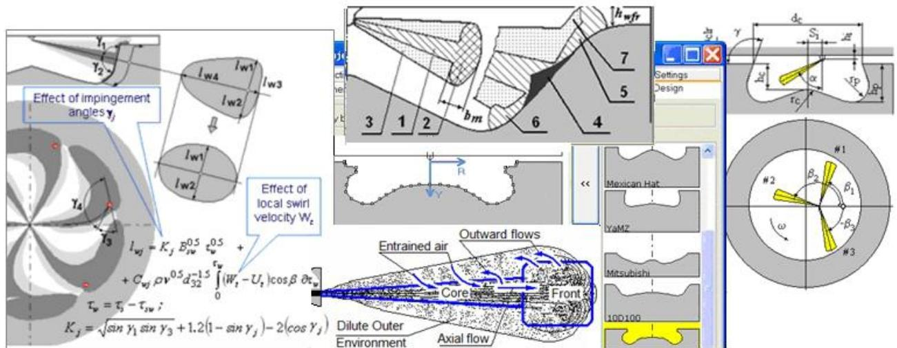
Новая модель сгорания позволяет оптимизировать форму камеры сгорания, параметры топливной системы (число, диаметр и направление топливных струй), а также стратегию многоразового впрыска и алгоритм управления системой Common Rail и системами рециркуляции ОГ во всем диапазоне работы.
