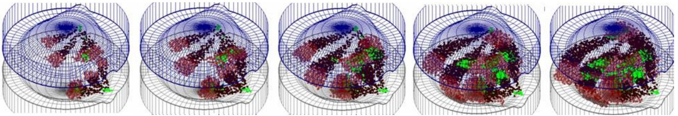
3D развитие топливных струй от 2-х форсунок в цилиндре 2-х тактного дизеля с ПДП и канавками в поршнях для подачи топлива в камеру сгорания (двигатель 18 ДПРН 23х2/30). Зелеными маркерами обозначены зоны пересечения струй в объеме КС, которые снижают скорость испарения и тепловыделения. Доли топлива в зонах пересечения выводятся на графики в функции угла поворота. Это позволяет проводить оптимизацию пространственной ориентации топливных струй.
