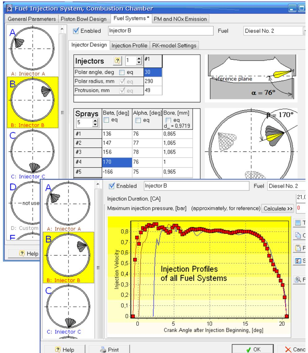
3D визуализация развития струй в камере сгорания позволяет анализировать особенности смесеобразования в ДВС и оптимизировать ориентацию сопловых отверстий.
